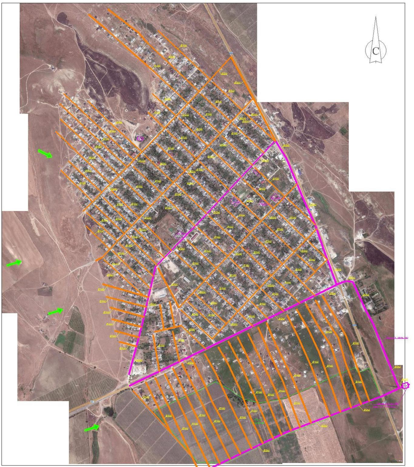
**Рис 12.1. Перспективная схема водоотведения с. Первомайское**
