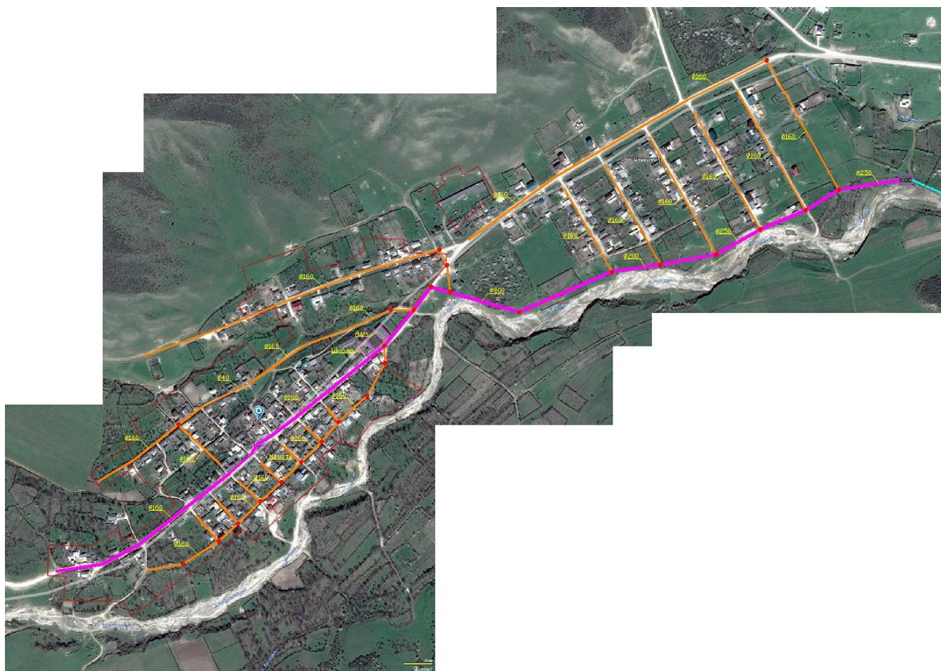
Рис 12.1. Схема водоотведения с. Капкайкент на перспективу
