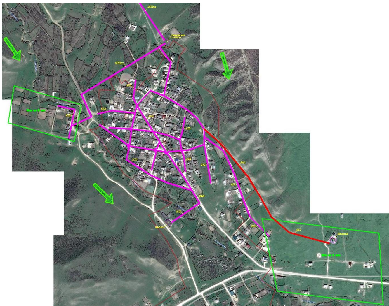
Рис.1.4.5.Схема существующих систем водоснабжения с. Джаванкент
